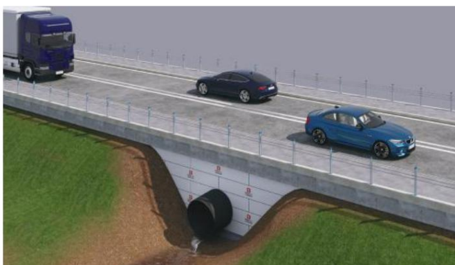
Figuur 3 Het wordt gebruikt in vullingen om ondergrondse pijpleidingen, drainage- en infrastructuurvoorzieningen te beschermen die onderhevig zijn aan hoge verticale belastingen.
