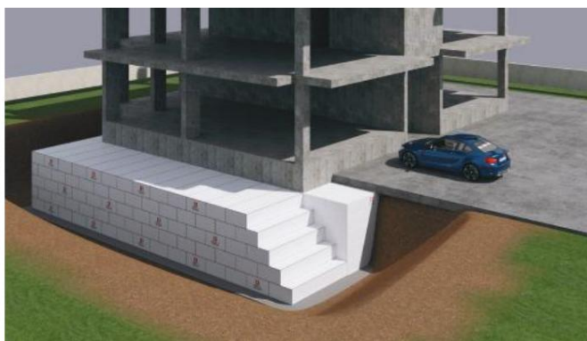
Figuur 4 Het wordt gebruikt bij vultoeppingen om laterale en seismische belastingen op keerconstructies en funderingen te verminderen.
